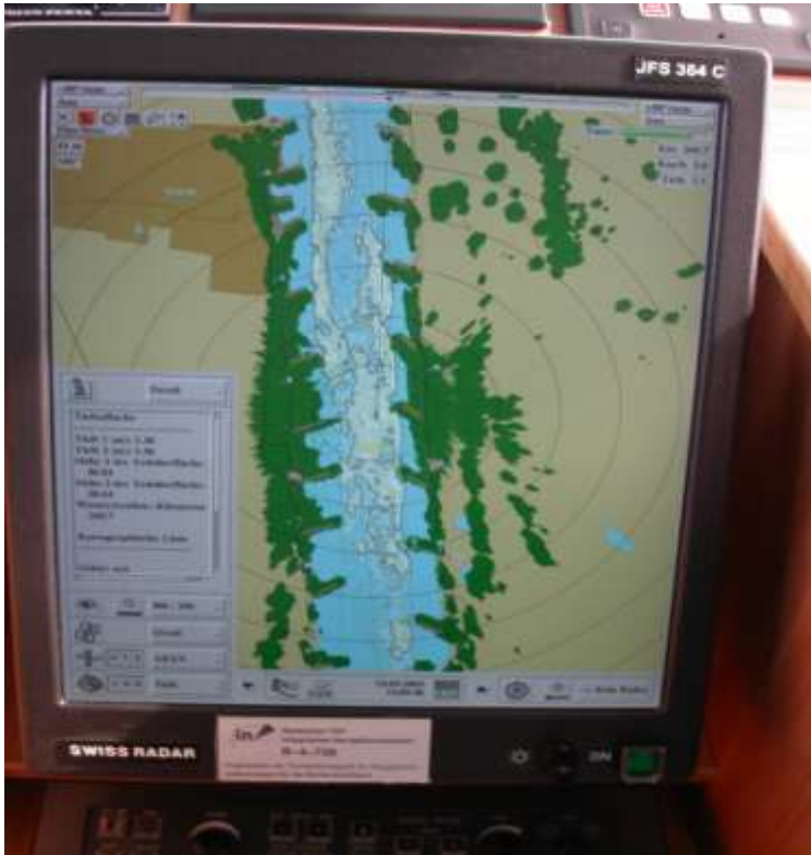
Monitor radaru na plavidle s podkladem plavební mapy Inland ECDIS a hloubkovou informací.
